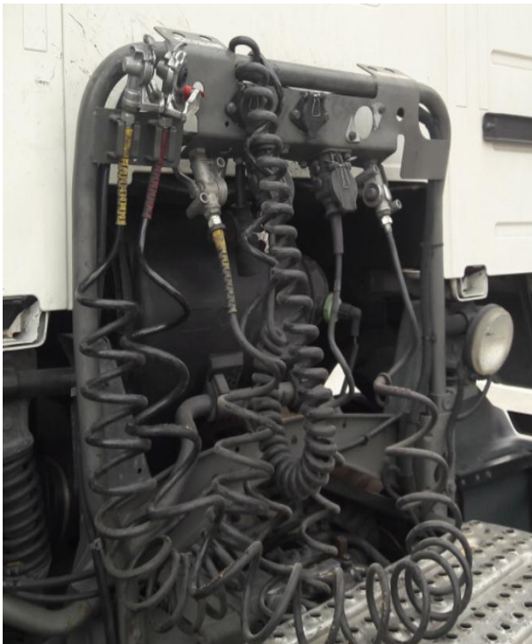
Εικόνα 7: Πλατφόρμα ζεύξης τράκτορα με τα καλώδια τροφοδοσίας ρεύματος και παροχής αέρα στο ρυμουλκούμενο
