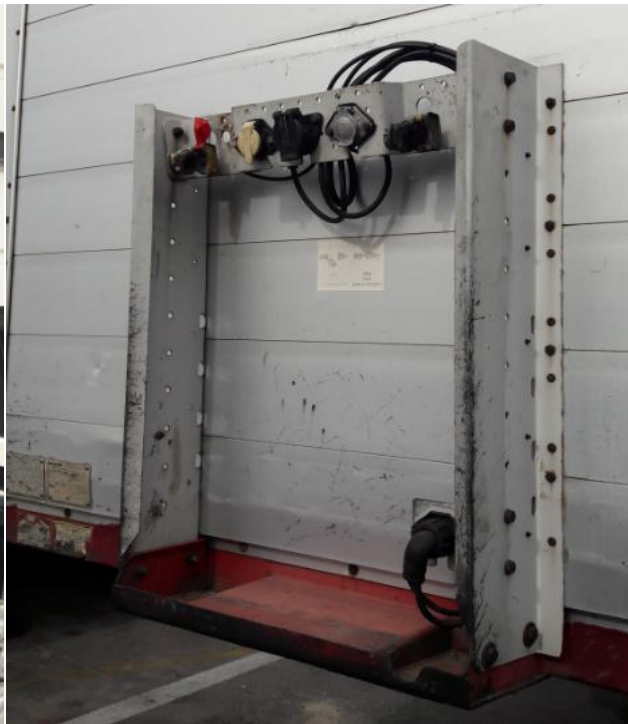
Εικόνα 8: Πλατφόρμα ζεύξης επικαθήμενου με τους υποδοχείς καλωδίων τροφοδοσίας ρεύματος και αέρα
