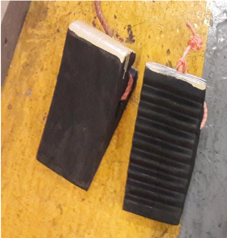
Εικόνα 12: Σφήνες αναστολής κύλισης (τάκοι) Φ/Γ οχημάτων
